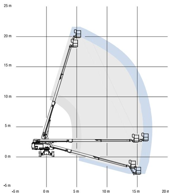
\* Altura de trabajo = Altura de la plataforma + 1,8 m
